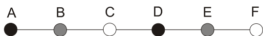
Obr. 3: Při řetězové topologii sítě lze TDMA realizovat ve třech slotech při libovolném počtu uzlů. V síti znázorněné na obrázku mohou vysílat ve stejném slotu dvojice uzlů AD, BE a CF aniž by na sousedních uzlech došlo ke kolizi
